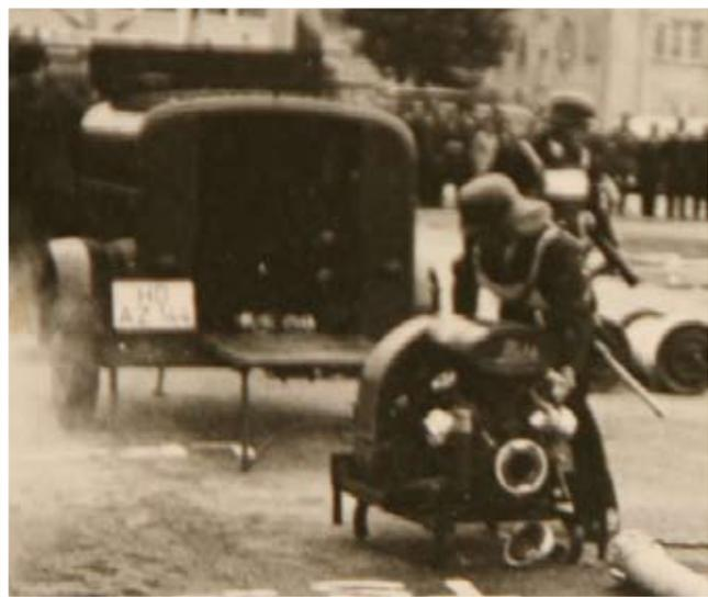
*Tragkraftspritzenanhänger mit TS8 - 1964*
