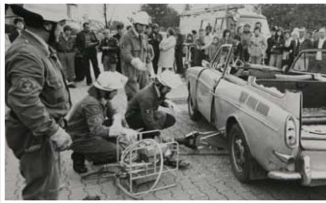
*Hydraulisches Rettungsgerät des Schnellrettungsfahrzeugs - 1976*
